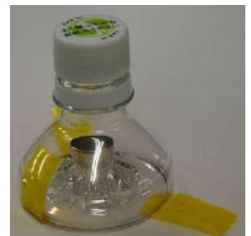
切ったペットボトルの底側にネオジム磁石を両面テープで張り付けて、 上側のペットボトルに取り付けます。
