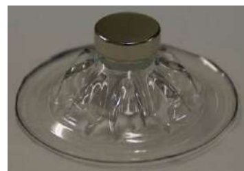
切ったペットボトルの底側にネオジム磁石を両面テープで張り付けて、 上側のペットボトルに取り付けます。
